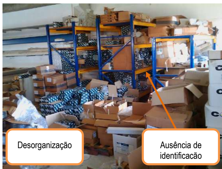
Figura 3.17- Zona de armazenagem dos componentes.
